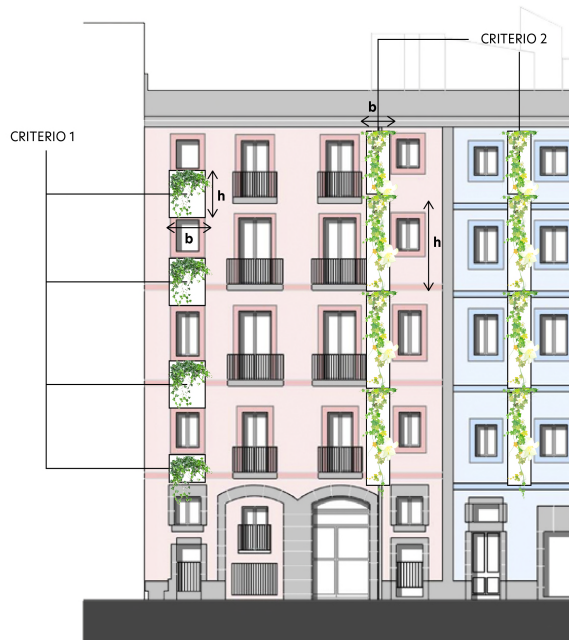
Figura 5.1: Esquema de una fachada tipo con los criterios de medición para la fachada verde modular
