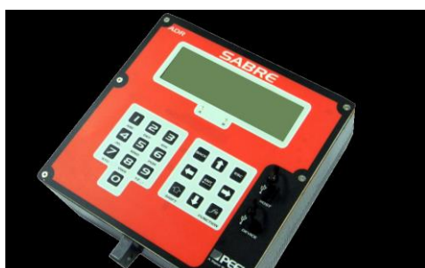
Ilustración 2 Aforador mediante tubo neumático
