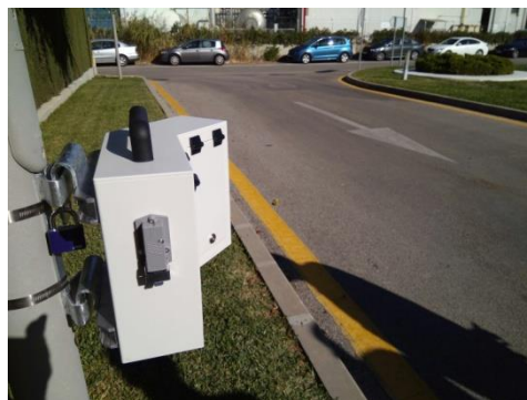
Ilustración 1 Aforador por tecnología Radar "Efecto Doppler"
