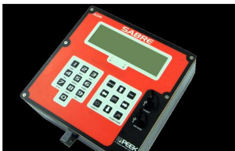
Ilustración 2 Aforador mediante tubo neumático
