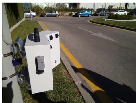
Ilustración 1 Aforador por tecnología Radar "Efecto Doppler"
