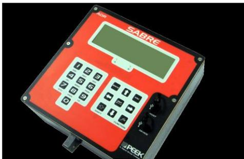
**Ilustración 2** Aforador mediante tubo neumático
