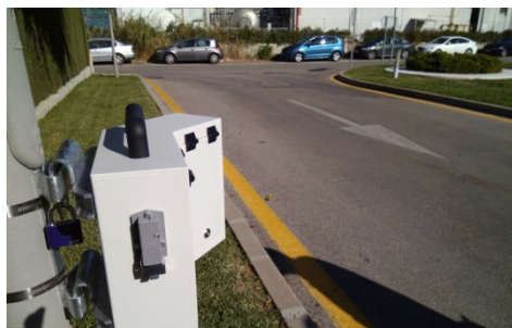
Ilustración 1 Aforador por tecnología Radar "Efecto Doppler"
