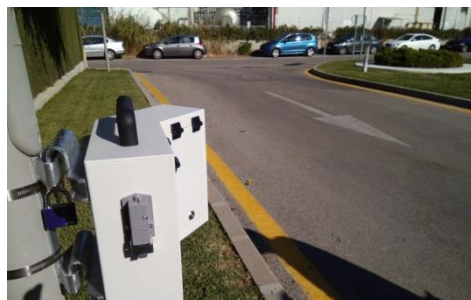
Ilustración 1 Aforador por tecnología Radar "Efecto Doppler"
