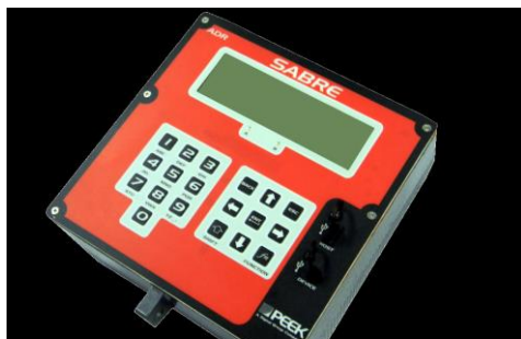
Ilustración 2 Aforador mediante tubo neumático
