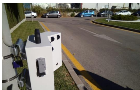
Ilustración 1 Aforador por tecnología Radar "Efecto Doppler"
