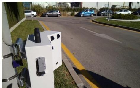
Ilustración 1 Aforador por tecnología Radar "Efecto Doppler"
