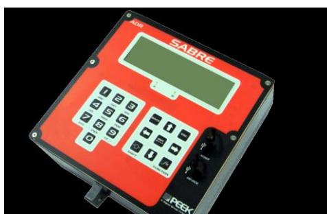
Ilustración 2 Aforador mediante tubo neumático
