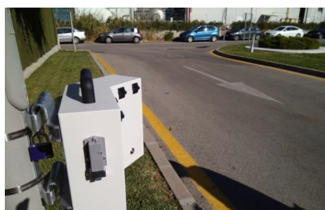
Ilustración 1 Aforador por tecnología Radar "Efecto Doppler"
