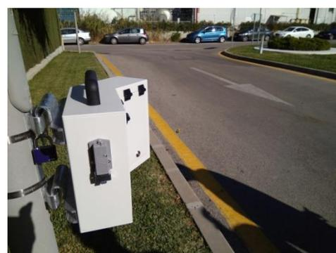
Ilustración 1 Aforador por tecnología Radar "Efecto Doppler"
