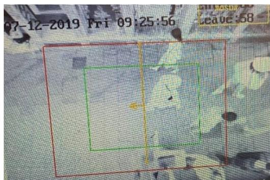
procesador permite procesar imágenes en 3D y con ello realizar contaje de peatones, en áreas de hasta 7 m. La imagen es procesada de tal forma que utilizando algoritmos de aprendizaje, junto a criterios de altura, permite conocer el número de personas que entran y salen de un área.
