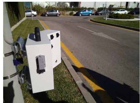
Ilustración 1 Aforador por tecnología Radar "Efecto Doppler"
