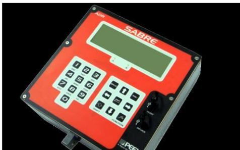
**Ilustración 2 Aforador mediante tubo neumático**
