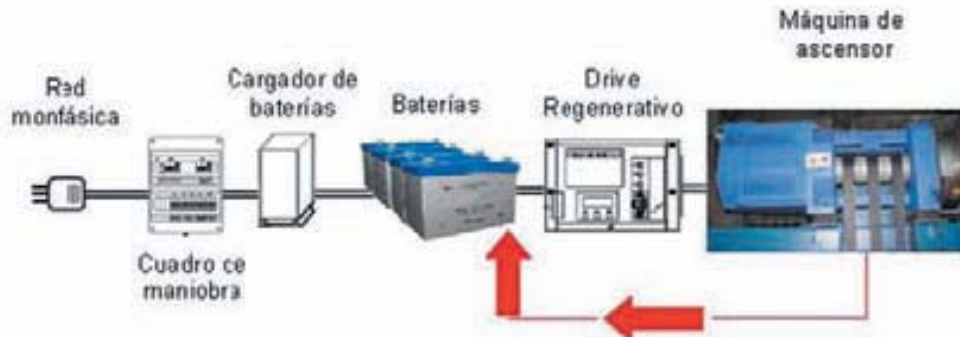
Esquema de funcionamiento del sistema de alimentación por baterías de un ascensor. (Fuente: Soluciones energéticamente eficientes en la edificación del IDAE)
