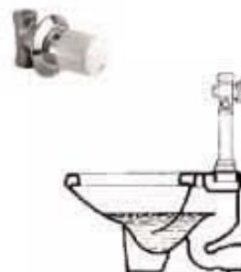
Ejemplo de cisterna con fluxómetro
