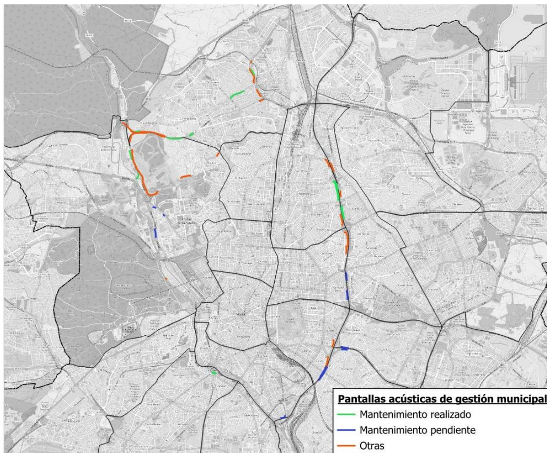
Ilustración 42. Estado del mantenimiento de las pantallas acústicas
