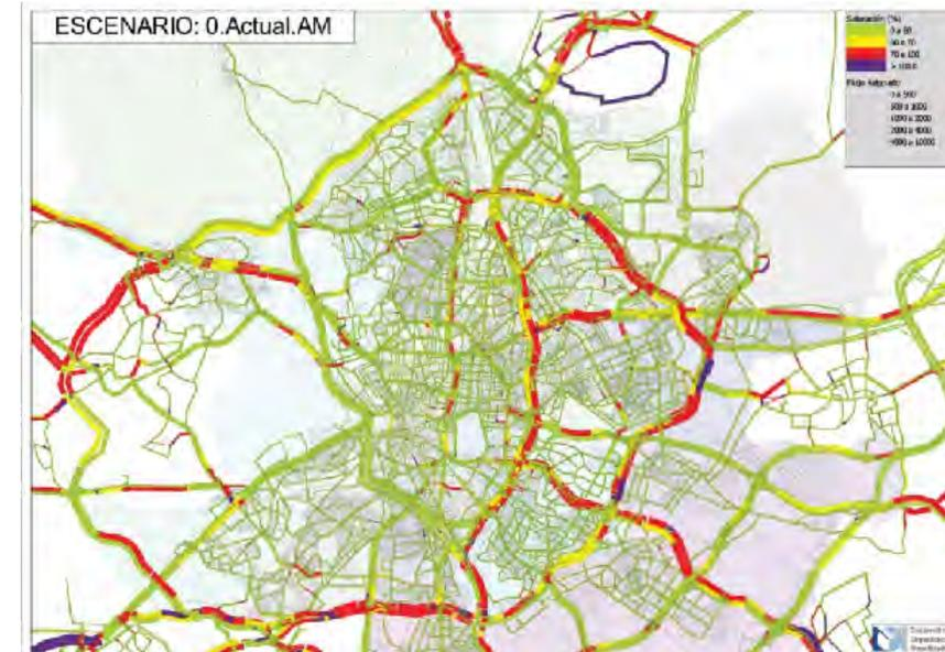
Ilustración 152. Intensidades de tráfico y nivel de saturación (Intensidad/Capacidad) en hora punta de mañana. Situación actual. Fuente: elaboración propia
