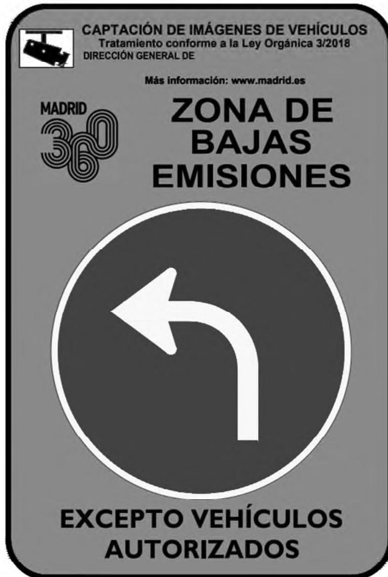
c) Señal de puerta de acceso de prohibido circular. Se situará a ambos lados de la embocadura de la calle donde comienza la restricción de tráfico. También se utilizará como formato de señal el cajón europeo de setenta por ciento veinte centímetros, incluyendo en su interior la señal R-100 de entrada prohibida excepto a vehículos autorizados.”
